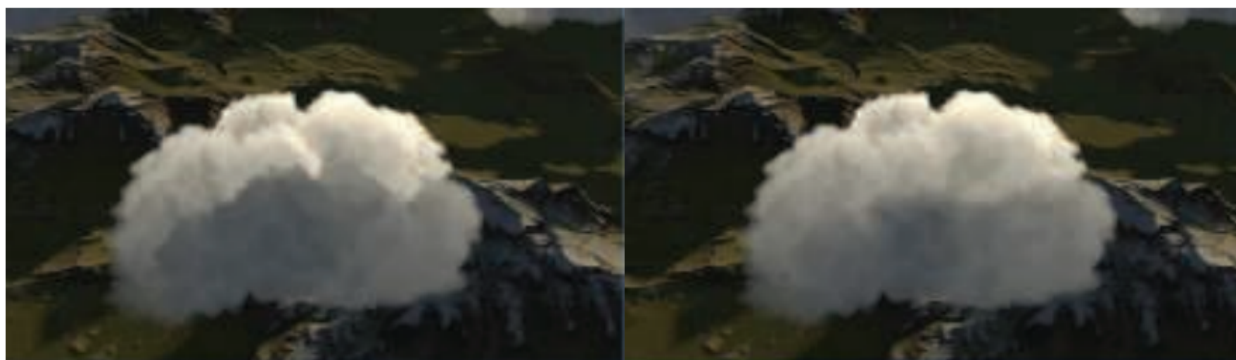
图 14.27：左边：云粒子以常规的方式进行渲染。右边：使用体积感知混合来进行粒子渲染。 [1959]
