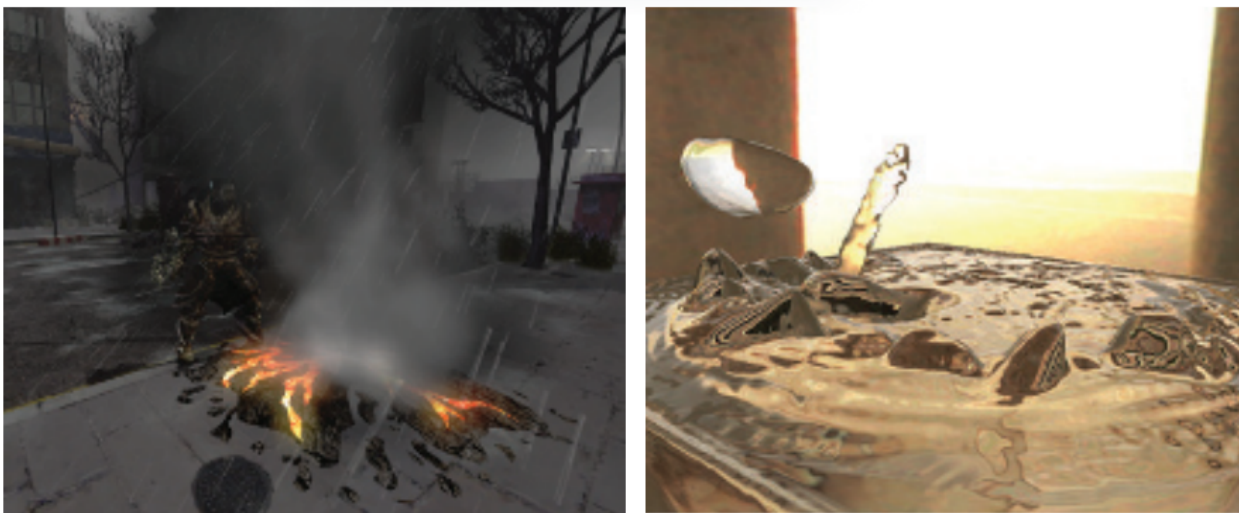
图 14.18：在 GPU 上使用体渲染与流体模拟相结合的技术来渲染烟雾和水体。 [303]
